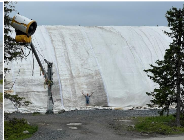
シートの下には人工降雪機で作った雪がある この雪で10月に5kmのコースができる
